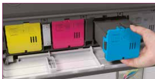
Los cartuchos de tóner se expulsan automáticamente cuando están completamente agotados.
